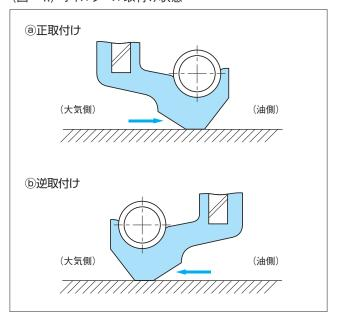
⑤において、油が大気側に漏れる時間あたりの量(正取付け時における流体送り込み量に相当)を計測することにより、オイルシールの持つ密封機能の一端を定量的に把握しようとしたものです。
